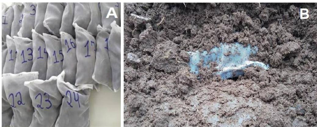
Abbildung 1: Set mit Schafdung gefüllter Netzbeutel vor der Ausbringung im Feld (A) Detail des Moments als der Versuchsbeutel in den Boden gelegt wurde (B)
