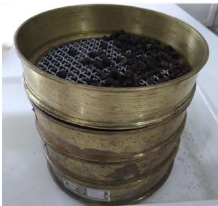
Abbildung 2 Sieb welches zur Trennung des Schafmists verwendet wird je nach Partikelgrösse (8, 4, 2 und 1mm)
